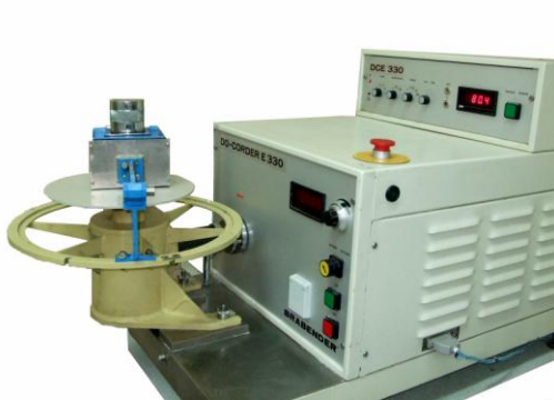
Рис.2. Прибор Do-Corder DCE-330 с насадкой для округления тестовых заготовок
